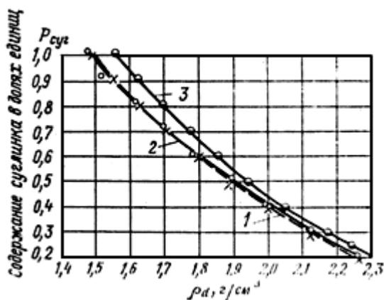
Рис. 5.4. Графики зависимости плотности смесей грунтов для ядер Сарсангской (кривая 1) и Верхне-Ханбуланчайской (кривые 2 и 3) плотин
