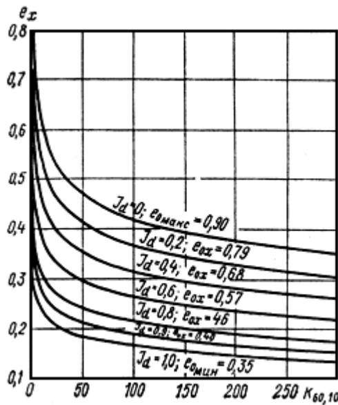
Рис. 4.1. График зависимости коэффициента пористости от коэффициента разнорзернистости
