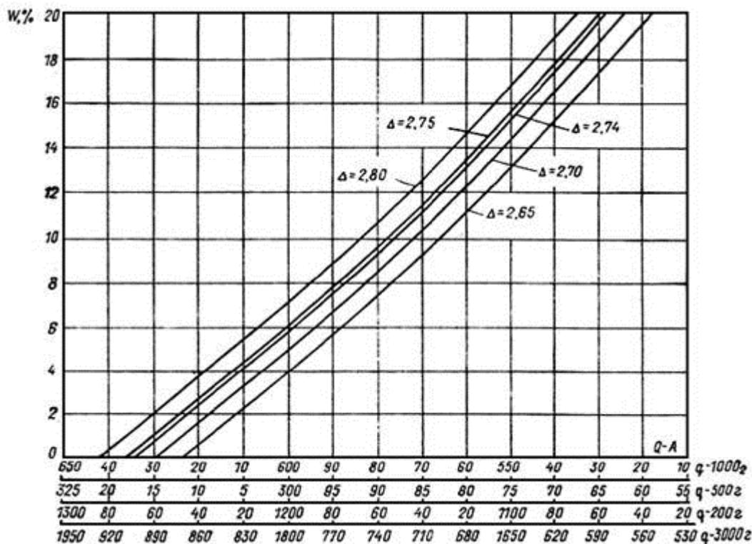
Рис. 9. График для определения влажности грунта объеметрическим методом
