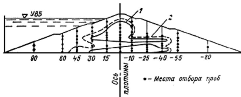
Рис. 70. Изолинии гранулометрического состава намытого грунта в поперечном сечении ПЛОТИНЫ
