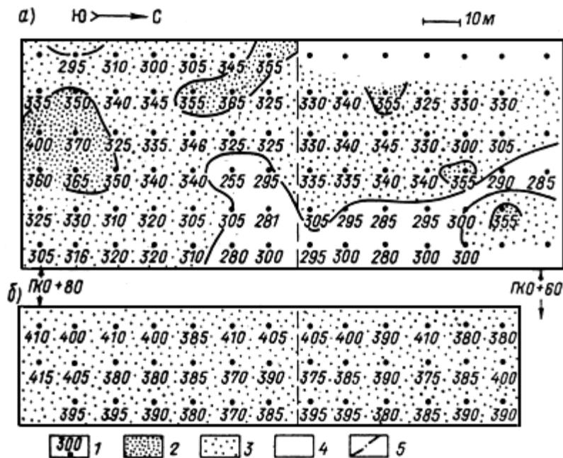
Рис. 42. Поля скоростей  $v_p$  в супесях Дангаринской насыпи при ее высоте 16 м. Мощность изучаемого яруса 1,5 м (а) и 3,0 м (б)
