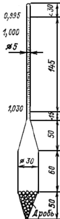
Рис. 6. Ареометр со шкалой 0,995-1,030 и ценой деления 0,001
