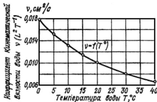
Рис. 55. График зависимости коэффициента кинематической вязкости воды от температуры
