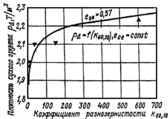
Рис. 64. График зависимости плотности сухих грунтов, уложенных в призмы, переходные зоны и ядро Нурекской плотины, от коэффициента разнородности
