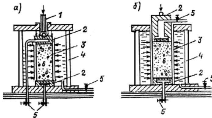
Рис. 25. Схема конструкции стабилometров
