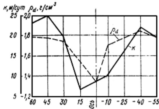
Рис. 68. График изменения плотности сухого намывного грунта и коэффициента фильтрации в пределах яруса сооружения (для неоднородной плотины)
