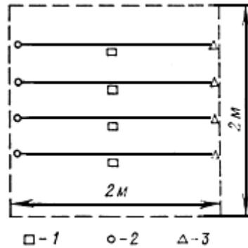
Рис. 41. Примерная схема размещения линий сейсмических измерений и отбора проб грунта
