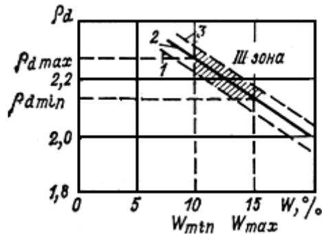
Рис. 62. График зависимости плотности сухого грунта от его влажности
