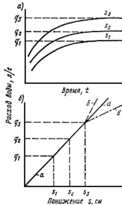
Рис. 48. Зависимость расхода воды  $q$  от понижения ее уровня в основании  $S$  и времени откачки  $t$  ( $a$ ) и в скважине ( $\delta$ )
