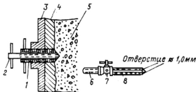
Рис. 54. Конструкция пьезометрического оголовка
