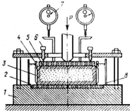
Рис. 21. Прибор для определения сжимаемости грунтов
