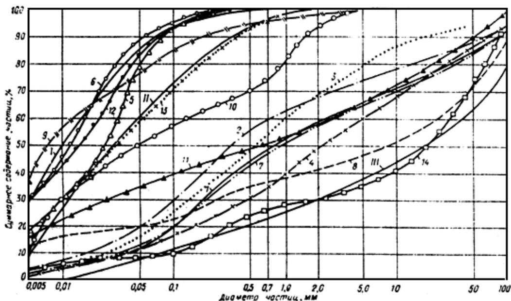
Рис. 3. Кривые гранулометрических составов грунтов, применяемых при возведении различных типов сооружений
