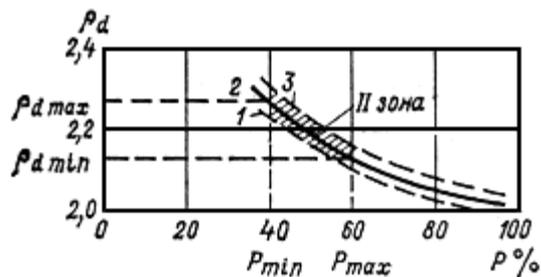
Рис. 61. График зависимости плотности сухого грунта от содержания мелкозема в составе грунта
