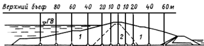
Рис. 4. Пример разбивки створов для отбора проб грунта на поперечнике плотины
