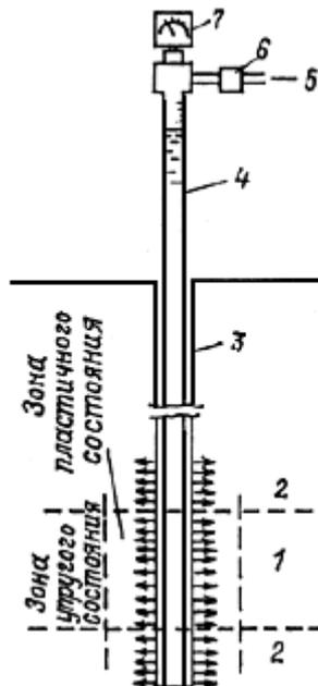
Рис. 57. Схема прессиометра (по Луи Менару)
