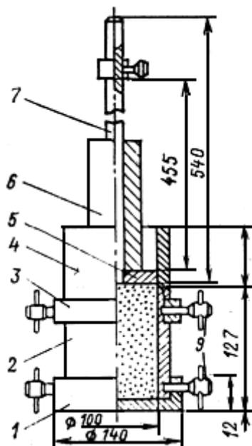
Рис. 12. Схема прибора СоюздорНИИ для стандартного уплотнения грунтов
