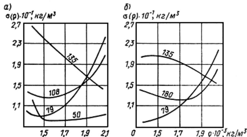
Рис. 3.3. Зависимость средней квадратической абсолютной погрешности измерения плотности  $\sigma(\rho)$  от ее абсолютных значений для сухих (а) и водозаполненных (б) скважин различного диаметра
