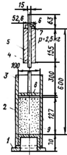
Рис. 14. Прибор для стандартного уплотнения грунта
