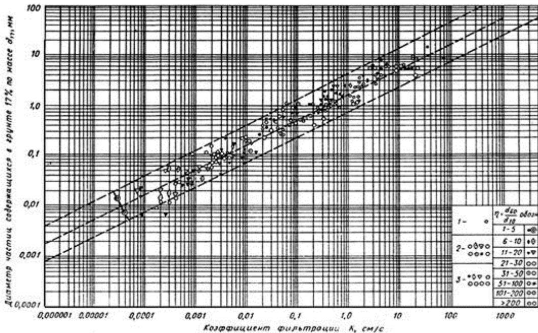
Рис. 56. Экспериментальная зависимость коэффициента фильтрации от величины  $d_{17}$
