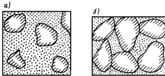
Рис. 5.1. Схема смеси грунтов из песка и камня при сплошном заполнении пор песком
