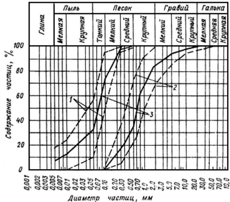
Рис. 1. Граничные и осредненные кривые гранулометрического состава грунта по зонам намывной плотины
