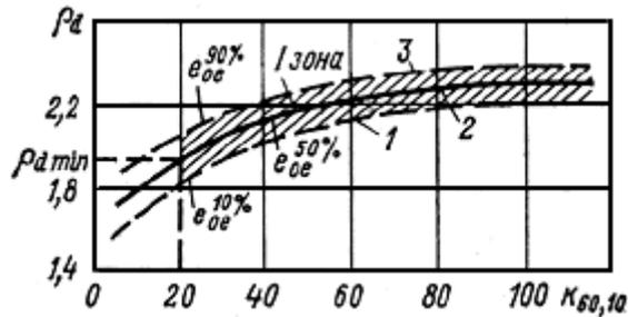
Рис. 60. График зависимости плотности сухого грунта от коэффициента разнорзерности при постоянном значении коэффициента пористости
