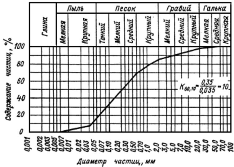
Рис. 65. Пример кривой однородности гранулометрического состава грунта
