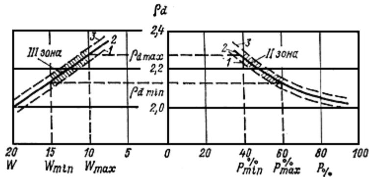
Рис. 63. График зависимости плотности сухого грунта от его влажности и содержания мелкозема в грунте
