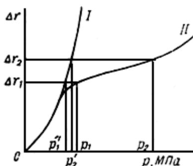
Рис. 58. График испытания грунта прессиометром
