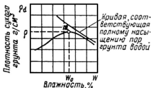
Рис. 15. Зависимость плотности сухого грунта от влажности
