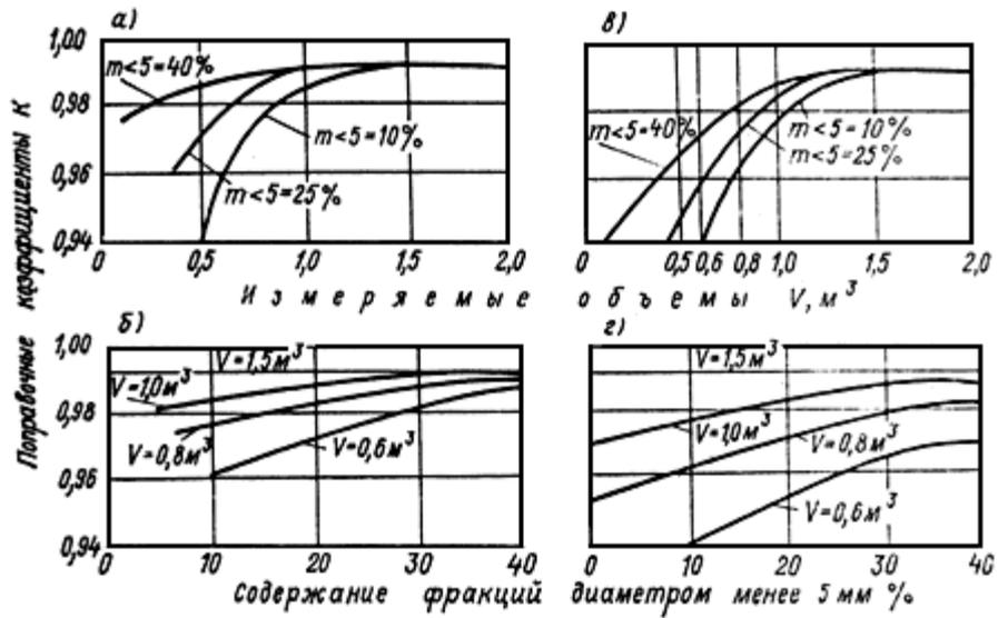
Рис. 2.4. Зависимости поправочных коэффициентов  $K$  от измеряемых объемов и содержания в галечнике мелкозема (фракция менее 5 мм)
