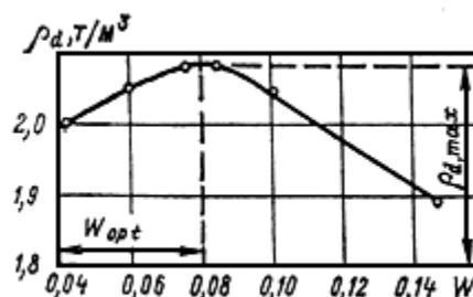
Рис. 20. График зависимости плотности сухого грунта от влажности при виброударном уплотнении удельным импульсом одиночного удара, равным  $49,25 \times 10^2$  Нс/м<sup>2</sup>
