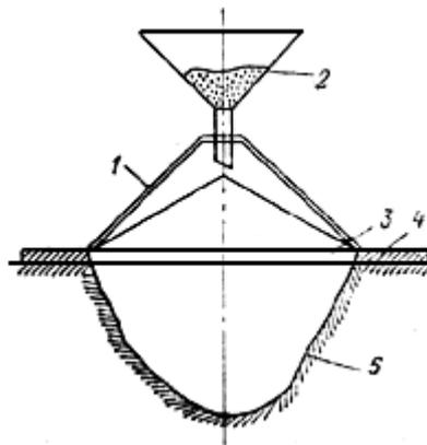
Рис. 2.1. Схема отбора проб грунта методом лунки
