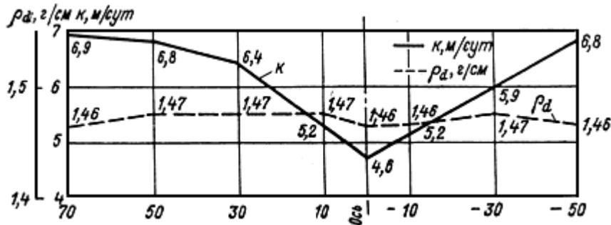
Рис. 69. График изменения плотности сухого намывного грунта и коэффициента фильтрации в пределах яруса сооружения (для однородной плотины)
