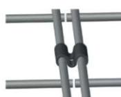
**Клипсовые скобы Р20** изготавливают из **оцинкованной** или нержавеющей стали, толщиной 1-1,5 мм. Расстояние между скобами должно быть не более 25 см. Соединение выполняется с помощью **специального инструмента – ручного клипсатора**, что ускоряет и упрощает процесс сборки габионов в крупном строительстве.
