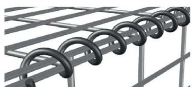
**Монтажные спирали** Основной и наиболее простой тип крепления сварного габиона. Спирали изготавливают из **оцинкованной проволоки** Ø 3,9 мм, что гарантирует долговечность конструкции и сохраняет эстетичный вид. Длина спиралей соответствует размерам рёбер сварного габиона. **Монтаж не требует специального инструмента.**
