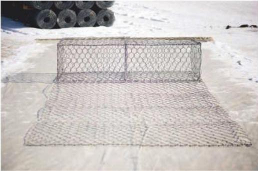
Конструкция имеет дополнительное полотно сетки, выступающее за пределы короба. При этом важно, чтобы дно габиона и армопанель были единым полотном. Если их изготавливают по отдельности и затем соединяют, это нарушение технологии.
