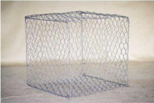
По форме это ящики из сетки. Обычно изготавливаются длиной от 1 до 4 метров, шириной в пределах 1-2 метров и высотой 0,5-1 метр. Внутри конструкции есть диафрагмы с шагом 1 метр: они повышают ее жесткость и прочность.
